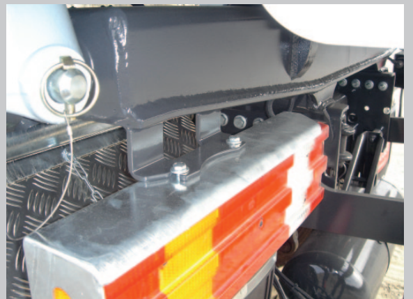
Heckleuchtenhalter mit verzinktem Schutzblech
