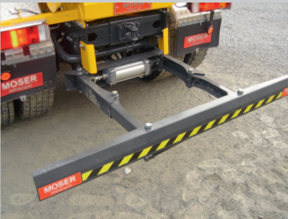
Unterfahrerschutz pneumatisch teleskopierbar
