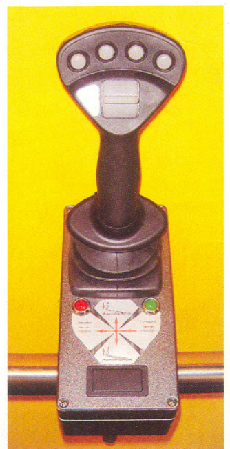
Haken offen: Mit dem Joystick kann die Zunge geöffnet werden.
