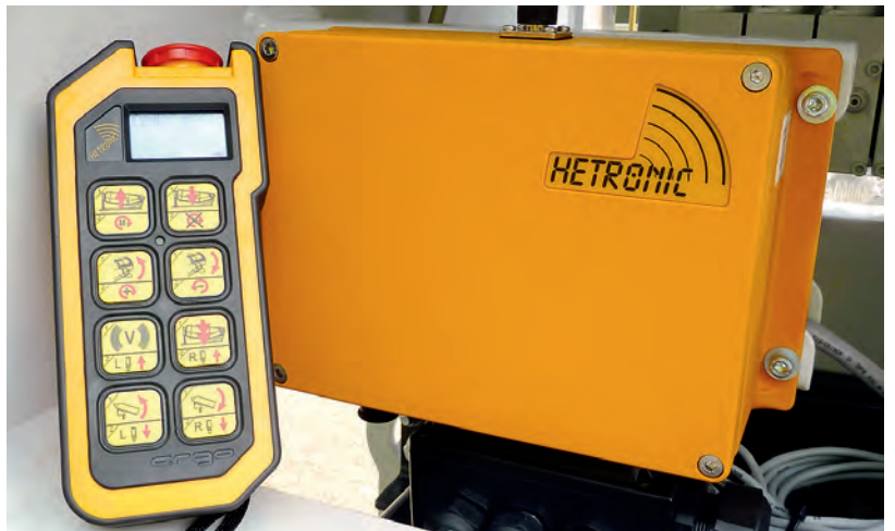
Das freut den Chauffeur: Eine Funkfernbedienung, welche ihm «Bewegungsautonomie» verleiht und mit welcher sich alle Funktionen direkt ansteuern lassen.
