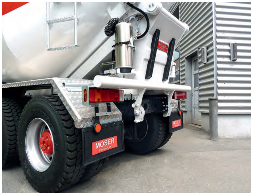
Der hintere Unterfahrtschutz lässt sich hochschwenken, um 150 Grad.
