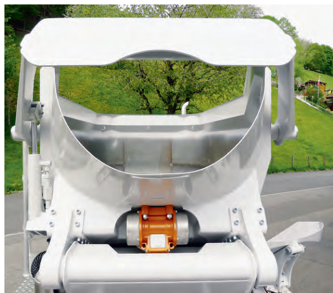
Mit der neuen Auslaufgeometrie lassen sich auch Kleinmengen fein dosiert abkippen.
