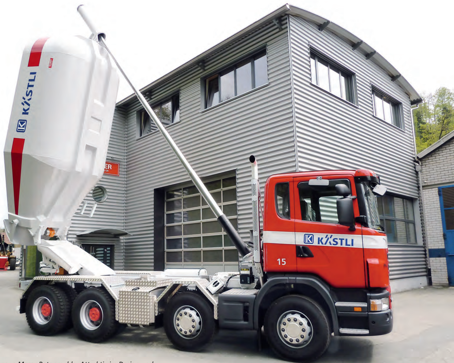
Die neue Moser Betonmulde: Attraktiv im Design und mit zahlreichen funktionalen Neuerungen versehen.
