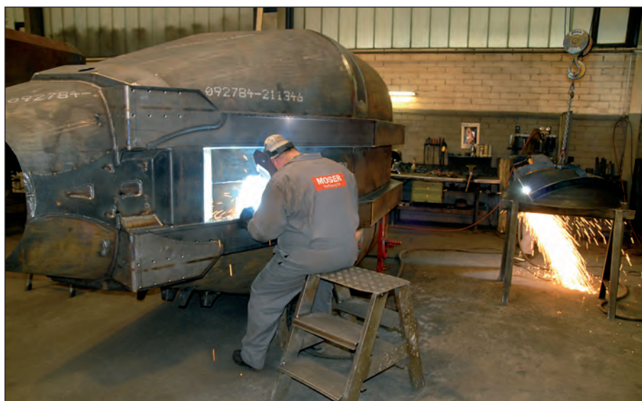
Passionnés: les frères Moser, Adrian (à gauche) et Christoph aiment travailler l'acier. C'est dans cette halle de production que les nouvelles bennes à béton sont assemblées et soudées.
