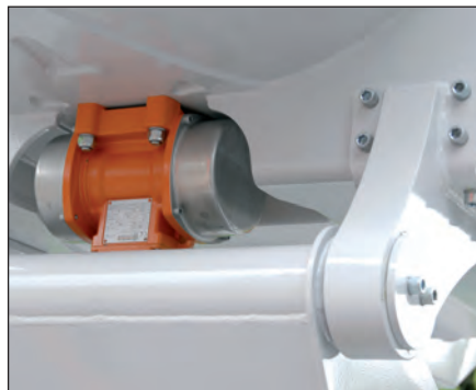
Détail: à gauche, la benne légèrement surélevée avec le coulisseau d'évacuation. On aperçoit les bordures de protection noires. A droite, la position protégée du vibreur.
