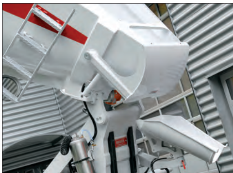
Détail: à gauche, la benne légèrement surélevée avec le coulisseau d'évacuation. On aperçoit les bordures de protection noires. A droite, la position protégée du vibreur.
