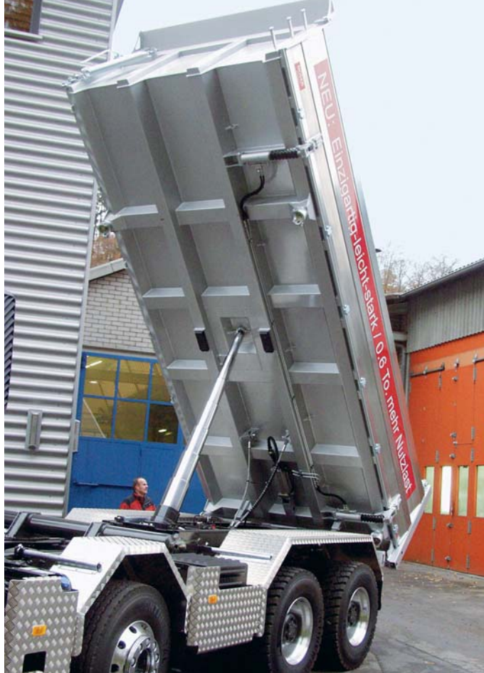
Leicht, aber stark: Der Blick unter die Bodengruppe zeigt die Anordnung der einteiligen Längs- und Quertraversen, die auch beim 40-Tonnen-Fünffachser eingesetzt werden.
