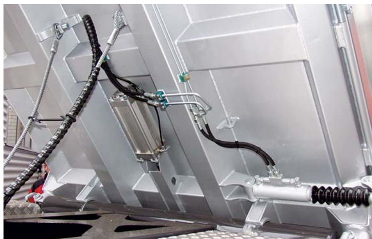
Saubere Technik: Die einteiligen Quertraversen werden in die Längsträger eingeschoben und mit ihnen verschweisst.
